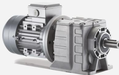
Les réducteurs à engrenages Série RD construits à partir d'une carcasse moulée en une pièce et avec support interne permettant l'adaptation de 2 ou 3 trains d'engrenages, sont fabriqués suivant les plus récentes normes ISO avec le concours d'analyses structurelles pour la vérification de la déformation et des contraintes.
